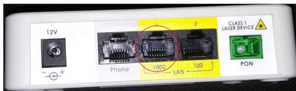
Рекомендуется производить настройку беспроводного маршрутизатора с компьютера или ноутбука, который имеет с ним проводное подключение, для которого следует соединить один из портов LAN на роутере с таким же портом на сетевой карте ПК.
